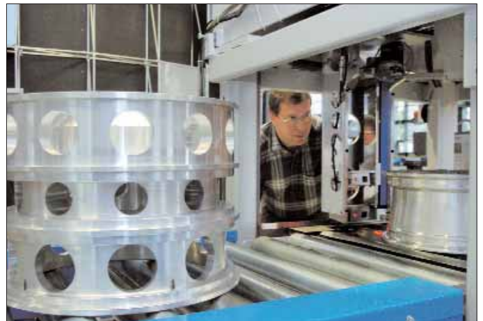
Qualitätskontrolle dreidimensional: Optische 3-D-Messtechnik zur Felgenvermessung.
