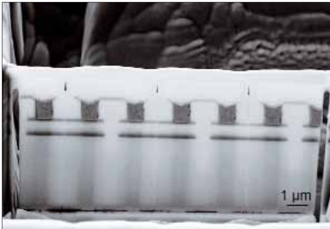
Elektronentransparente Lamelle einer mikroelektronischen Teststruktur
