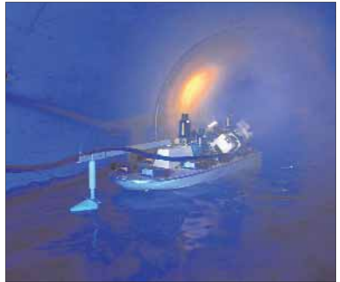
Inspektions- und Reinigungsroboter im Emscher-Kanal.
