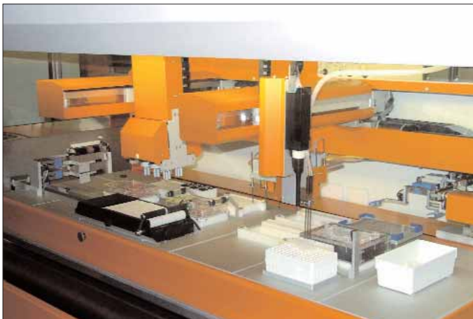
Laborautomatisierung aus dem Fraunhofer IFF: Das Herzstück der Anlage bildet die eigens dafür entwickelte Pipetierstation. Sie ist in der Lage, zwei Multischalen gleichzeitig zu pipetieren, abzusaugen oder auch Proben zwischen beiden auszutauschen.
