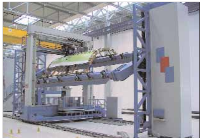
Nietvermessungsanlage bei Airbus
