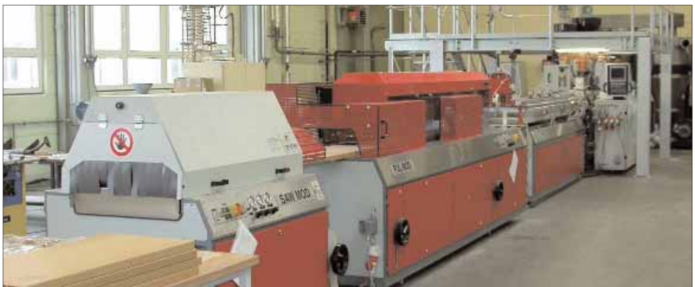
Extrusionsanlage für Hohlkammerprofile im Fraunhofer IWM
