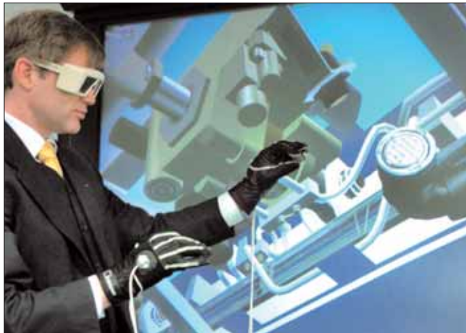
Wartung oder Reparatur einer virtuellen Hydraulikeinheit am Querruders
