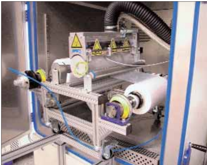
Coronastation mit Folienwickelanlage im Klimaschrank zur Realisierung von Oberflächenbehandlungen unter variablen Umgebungsbedingungen
