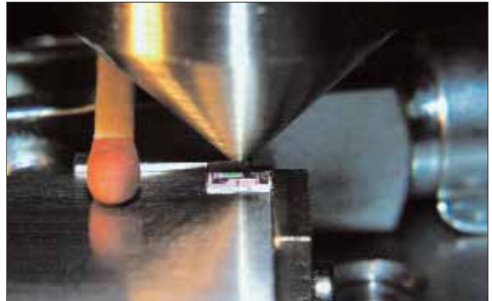
Versuch zur Festigkeitsbestimmung von Silizium-Chips. Zum Größenvergleich ist ein Streichholzkopf dargestellt.
