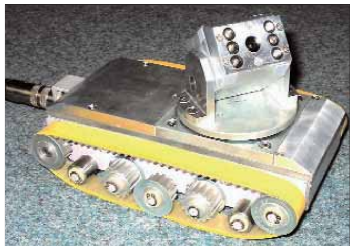
Der mobile Mini-Roboter inspiziert Lüftungskanäle.
